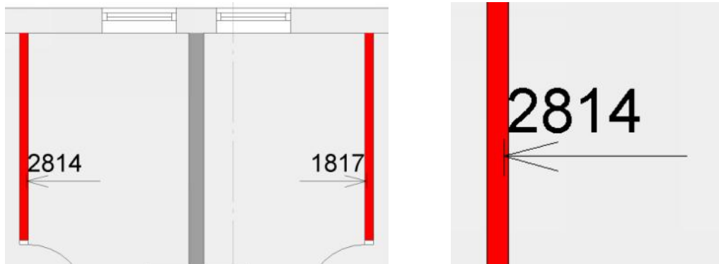
Figur 42, Utsättningsvänlig måttsättning: pilmått till regeln/skenans placering.
